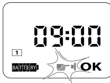
**IT PROGRAMMAZIONE PRIMA IRRIGAZIONE - Apertura.** Dopo aver impostato l'ora corrente, premere la freccia destra per entrare nella pagina del programma 1. Appare l'orario 00:00 preceduto da 1 (programma 1). Premere il tasto centrale ENTER. Sul display appare OK ad indicare che si può impostare l'orario di apertura utilizzando le frecce (es. 05:00); sul display, in alto, si visualizza 1 (programma 1). Confermare l'orario premendo ENTER.
